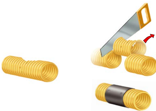
Usunięcie uszkodzonego odcinka rury karbowanej z PCV
