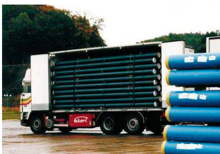
Prawidłowy przewóz rur z PVC
