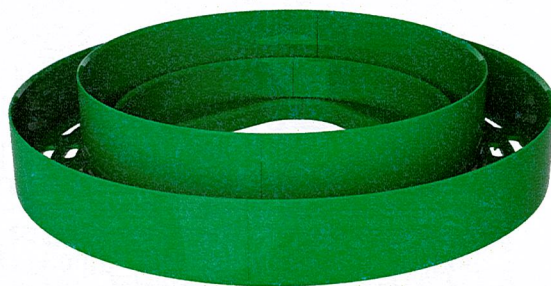
Rysunek A13. Adapter do rury trzonowej studzienki o średnicy DN/OD 400, DN/ID 425 i DN/OD 630, wykonany z polipropylenu (PP)
